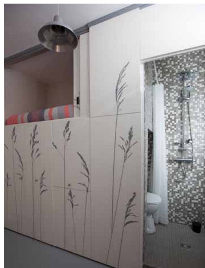
La salle d'eau est optimisée afin d'accueillir un sanitaire (Sani broyeur), une douche à l'italienne et un petit lavabo agrémenté de tablettes de rangements. Photo: Fabienne Delafraie
