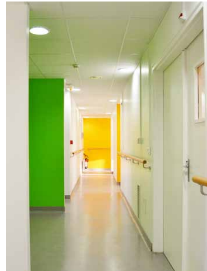
L'espace de circulation est différencié des autres zones grâce à un revêtement de sol de couleur plus sombre qui donne la direction du cheminement.
